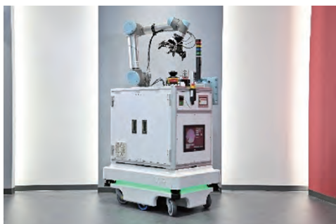
AMRと協働ロボットを組み合わせた 自律移動型協働ロボットシステム
