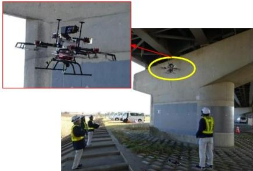
図3-20 ロボットやドローンを使用した測量・調査の事例
