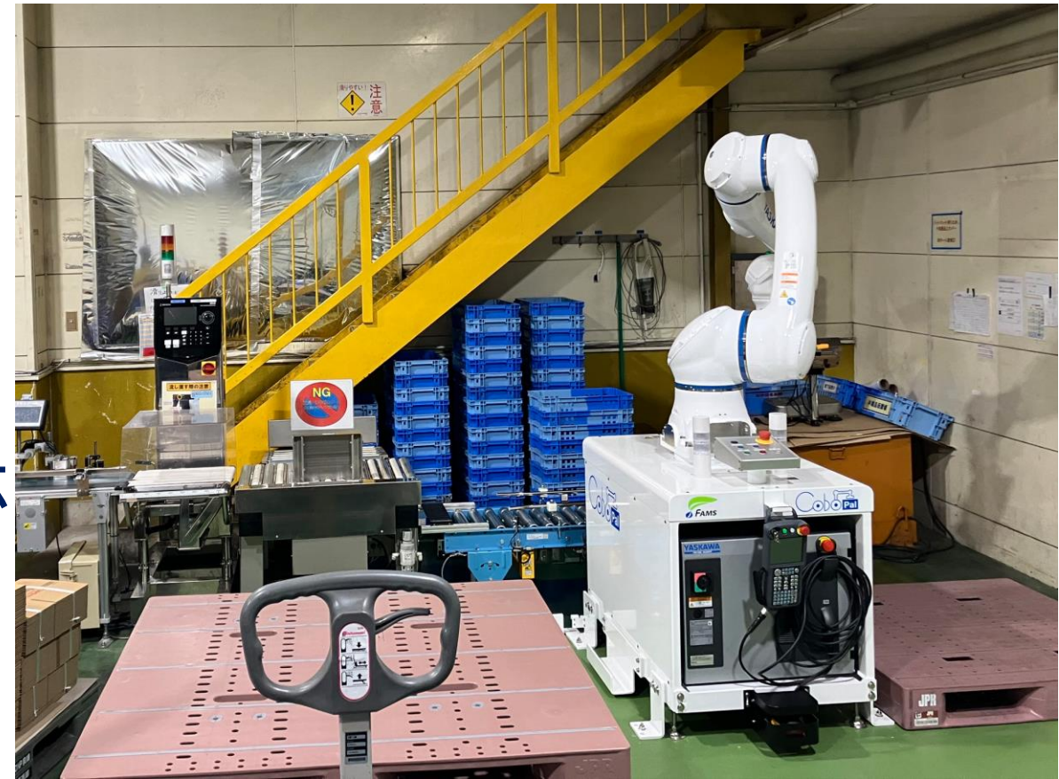
番重／個装箱移載ロボットシステム カネ力食品(株)
