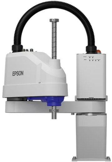
エプソンのスカラロボット T-3Bシリーズ 可搬重量：最大 3 kg
