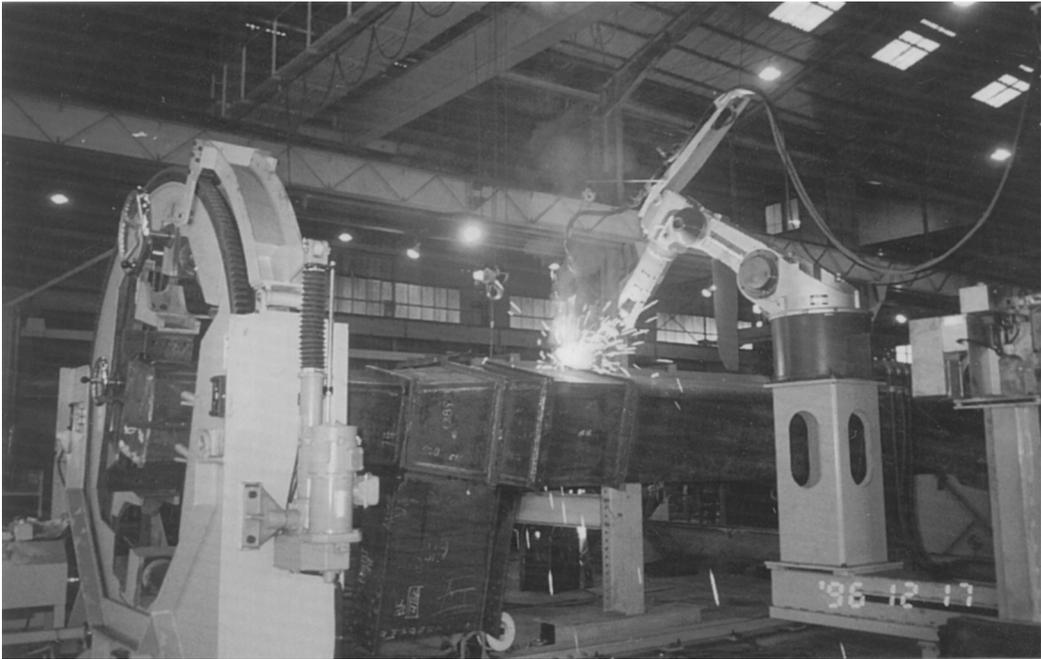
写真3 多関節型溶接ロボットの例 (コマツエンジニアリング(株) 提供)
